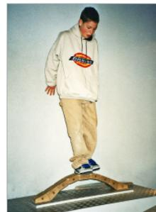
Eckhard hat diese Brücke aus Holzklötzen gebaut. Die beiden Endsteine sind am Boden festgeschraubt, alle anderen Klötze ohne Klebstoff einfach nur zusammengelgt. Er ist noch skeptisch, aber die Brücke hält sein Gewicht aus.
