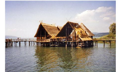
Das Steinzeitdorf, das in Unteruhldingen am Bodensee nachgebaut wurde, scheint überschwemmt zu sein. Es ist aber eine sehr intelligente Konstruktion. Das Dorf steht auf Pfählen im See, der Wasserstand kann variieren, ohne es zu überschwemmen.
