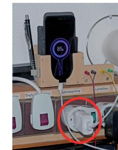
Die **Ladegeräte** von Smartphones sind vermutlich die am weitesten verbreiteten Transformatoren. Sie regeln die Spannung von 230 Volt aus der Steckdose auf 5 Volt für den Akku des Smartphones herunter.
