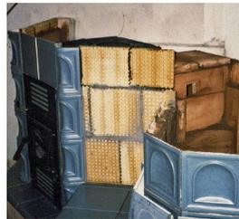
In dem Lehmklotz sind vier Züge. Der heiße Rauch wird also in Kurven durch den Heizkörper geleitet, bevor er in den Schornstein steigt.
