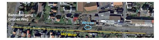
Es ist nicht möglich, dass die Züge in Buseck immer vom gleichen Bahnsteig abfahren. Wollen die Züge auf Gleis 1, müssen sie vor und nach dem Bahnsteig über Weichen und deshalb langsamer fahren. Bei der Ausfahrt darf der Zug nur 25 Km/h bis zum Bahnübergang "Grüner Weg" fahren. Dadurch würden drei bis vier Minuten verloren gehen.
