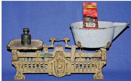
Diese Waage nutzt die Schwerkraft. Das Gewicht in der Schüssel wird mit Gewichtssteinen verglichen. Sind beide Waageschalen auf gleicher Höhe, dann ist das Gewicht auf beiden Seiten gleich.
