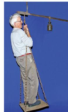
Helmut Seipp zeigt, wie eine Hebelwaage funktioniert. Ein kleines Gewicht reicht, um ihn mit der Waage im Gleichgewicht zu halten.
