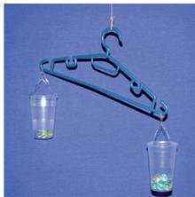
Eine solche Waage kann man mit einem Kleiderbügel und zwei Bechern leicht selbst bauen. Der Kleiderbügel wird an einer Schnur aufgehängt.
