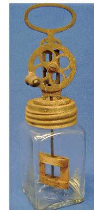
In welcher Küche gibt es keine Salatschleuder? Sie ist eine Zentrifuge. Der gewaschene und nasse Salat wird in einen Korb gelegt. Dieser Korb wird in die Schüssel eingebaut und kann über Zahnräder mit einer Leier schnell gedreht werden. Durch die Fliehkraft wird das Wasser in dem Korb nach außen geschleudert.
